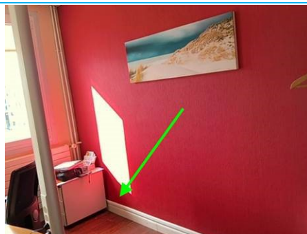
Matériaux : ZPSO-025 Prélèvement : P033 Description : Enduit à base de plâtre lissé ou taloché+Revêtement mural Localisation : 3ème étage Aile C - Serveur Résultat : Absence d'amiante
