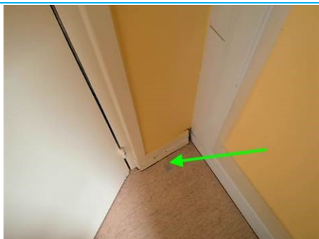
Matériaux : ZPSO-026 Prélèvement : P035 Description : Colle non bitumineuse+Revêtement lino+Chappe Localisation : 3ème étage Aile C - Dgt 3 Résultat : Absence d'amiante
