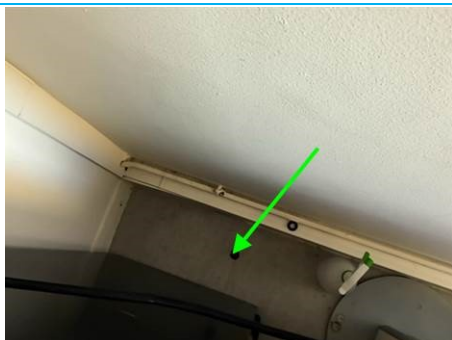
Matériaux : ZPSO-020 Prélèvement : P026 Description : Ragréage sous revêtement de sol récent Localisation : 3ème étage Aile C - Bureau 330 Résultat : Absence d'amiante
